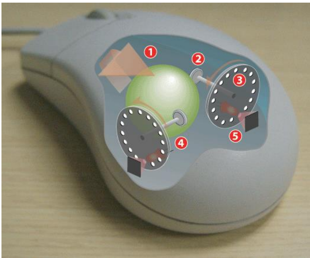
Układ sterowania kulkowej myszy komputerowej
